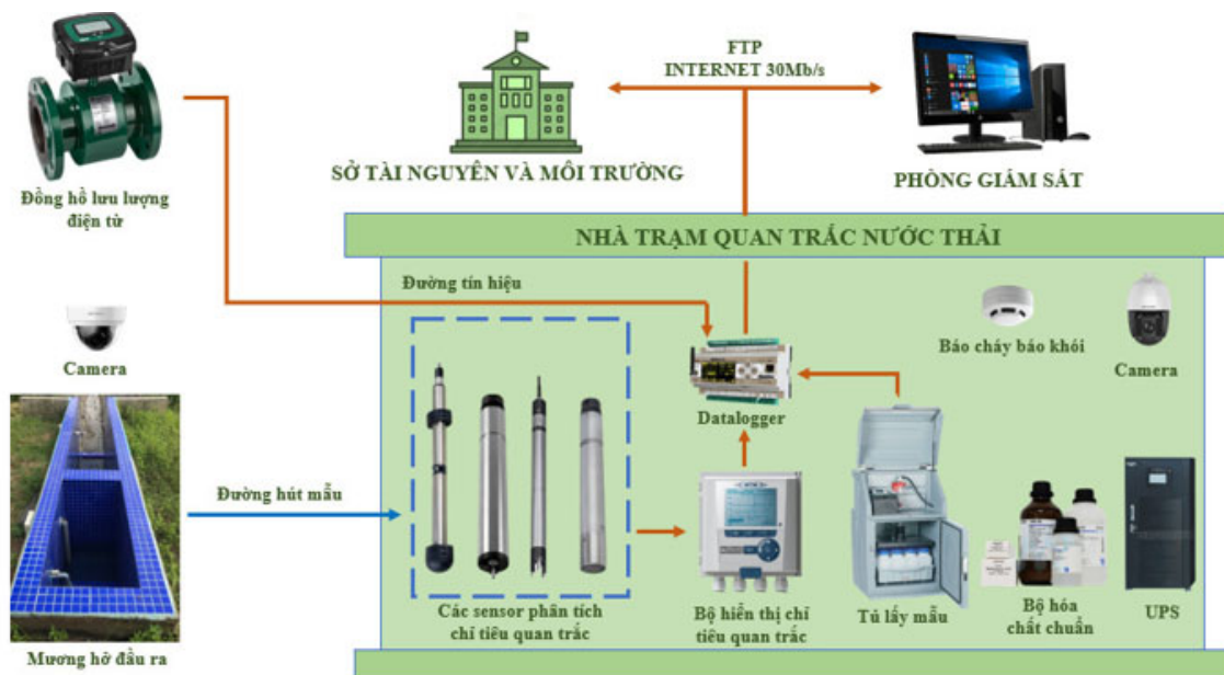
Hình 3.4. Sơ đồ mô phỏng tổng quan Trạm quan trắc nước thải tự động, liên tục
