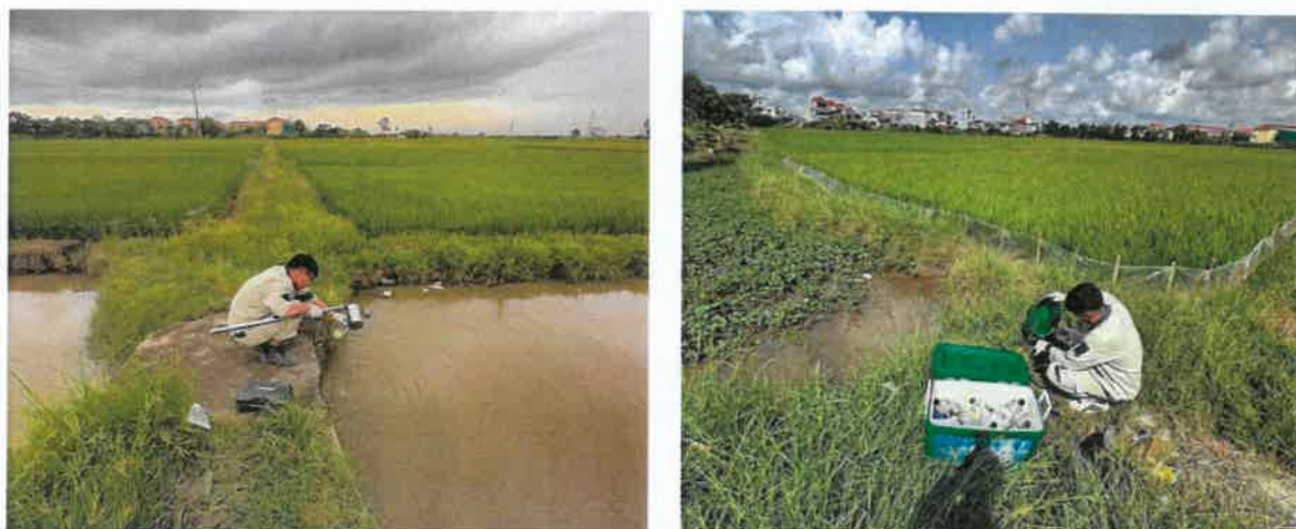
Hình 45. Quá trình lấy mẫu môi trường nước mặt tại mương tiêu phía Nam
